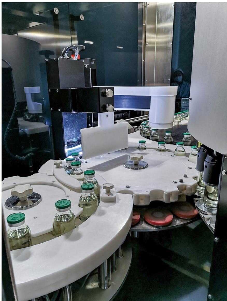
玻璃输液生产线上，修复后正在运行的自动灯检机驱动星轮（右）。沈钢 摄
